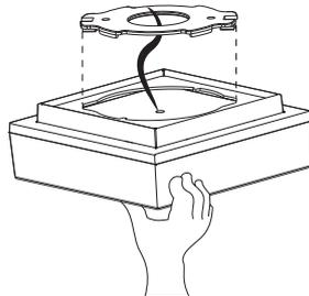
3. Encaixar a peça no suporte já fixado, gire a base no sentido horário para travar e no sentido anti-horário para destravar.
