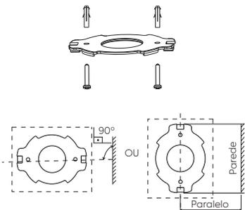
Somente nos modelos quadrados. A furação do suporte no teto ou parede deverá ser seguido para assegurar o alinhamento das luminárias com o ambiente.
