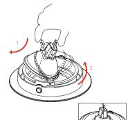
5. Faca a ligação à rede elétrica local isolando a corretamente (verifique se há necessidade do uso do transformador em algumas luminárias). Encaixe a lâmpada no soquete. Encaixe a tampa frontal no aro iá fixado ao teto.
